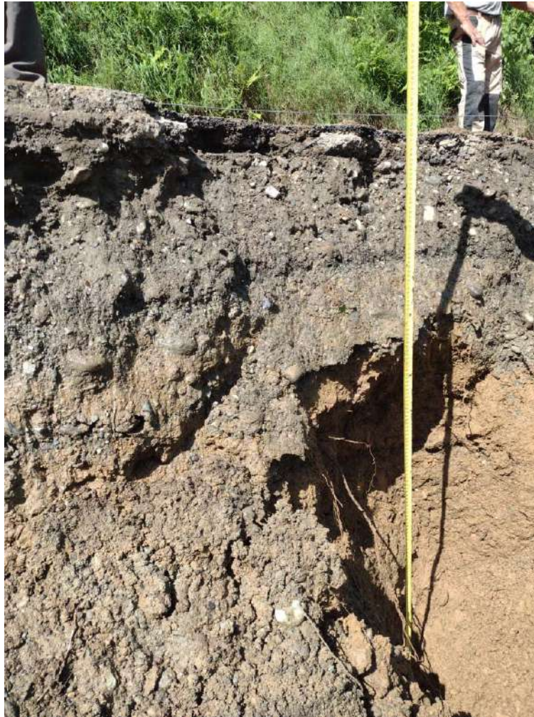
Figura 10: particolare della stratigrafia della carreggiata in corrispondenza della nicchia di distacco (si denota la presenza di materiale di riporto e terreno derivante dall'alterazione del basamento cristallino sino alla profondità di 200 cm, limite oltre il quale non è stato possibile procedere con l'indagine per esigenze di sicurezza)
