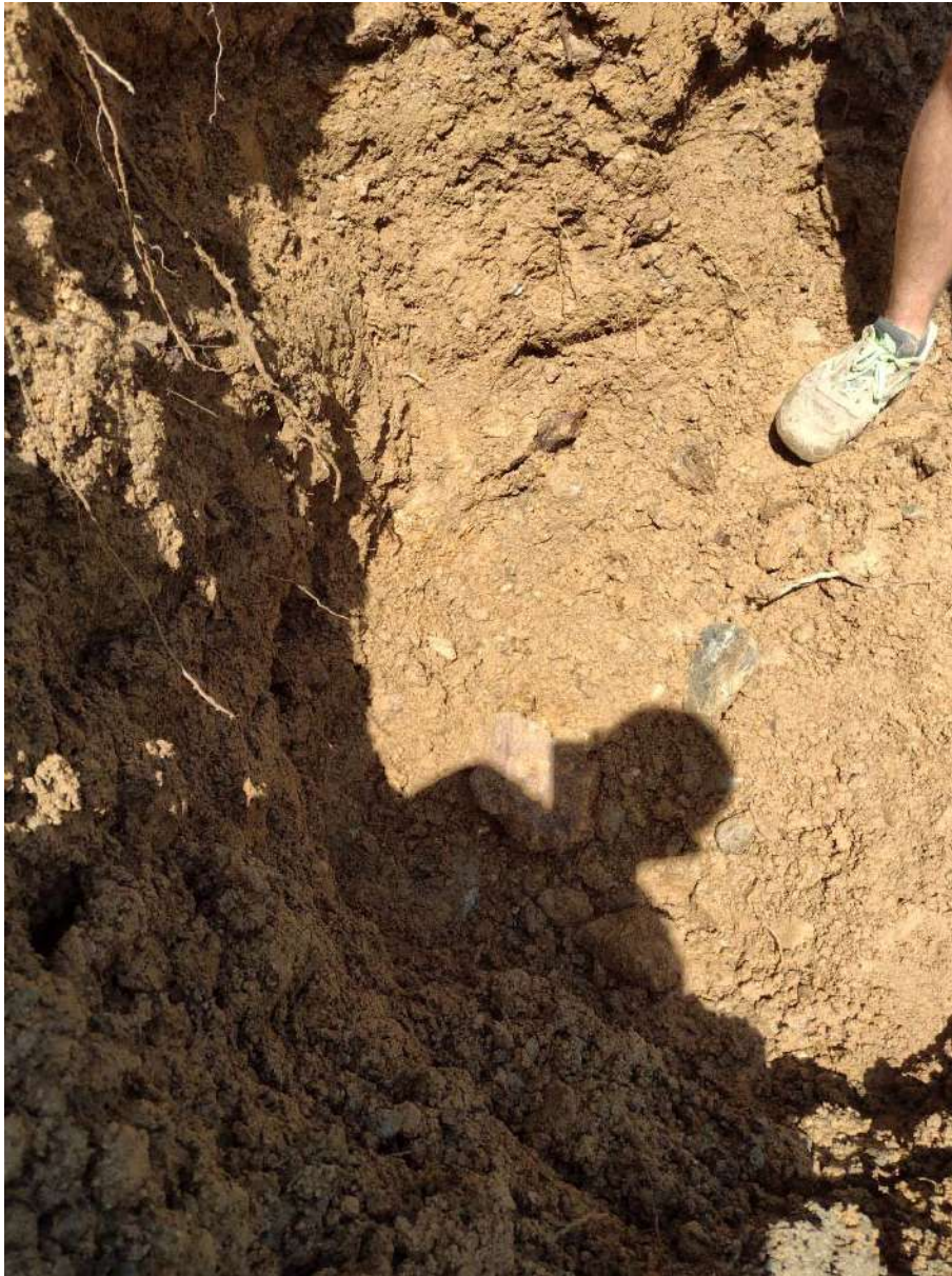
Figura 11: materiale sciolto rinvenuto alla profondità di circa 200 cm dove inizia presumibilmente il substrato roccioso superficiale alterato.
